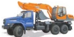
Тверской завод по производству строительно-дорожной техники UMG передал в опытную эксплуатацию экскаватор E195A на шасси «Урал NEXТ». Машина будет эксплуатироваться в городе Урай, Ханты-Мансийского автономного округа и предназначена для разработки котлованов, траншей, земельных работ в грунтах I-IV категорий, а также для оптимизации штата техники при копании, рыхлении и погрузке грунта, кировке дорожных покрытий, сносе строений, ремонте труб в любой отрасли.
