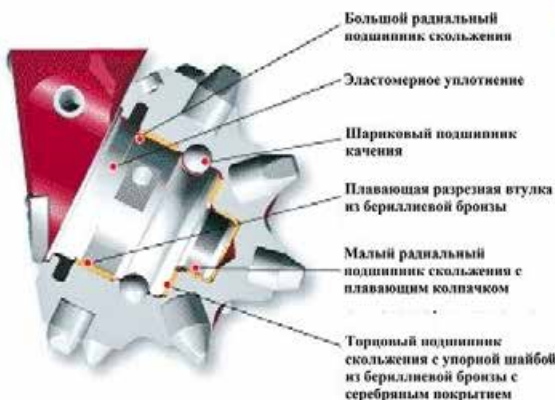
Устройство шарошки в трехшарошечном долоте с твердосплавным вооружением
