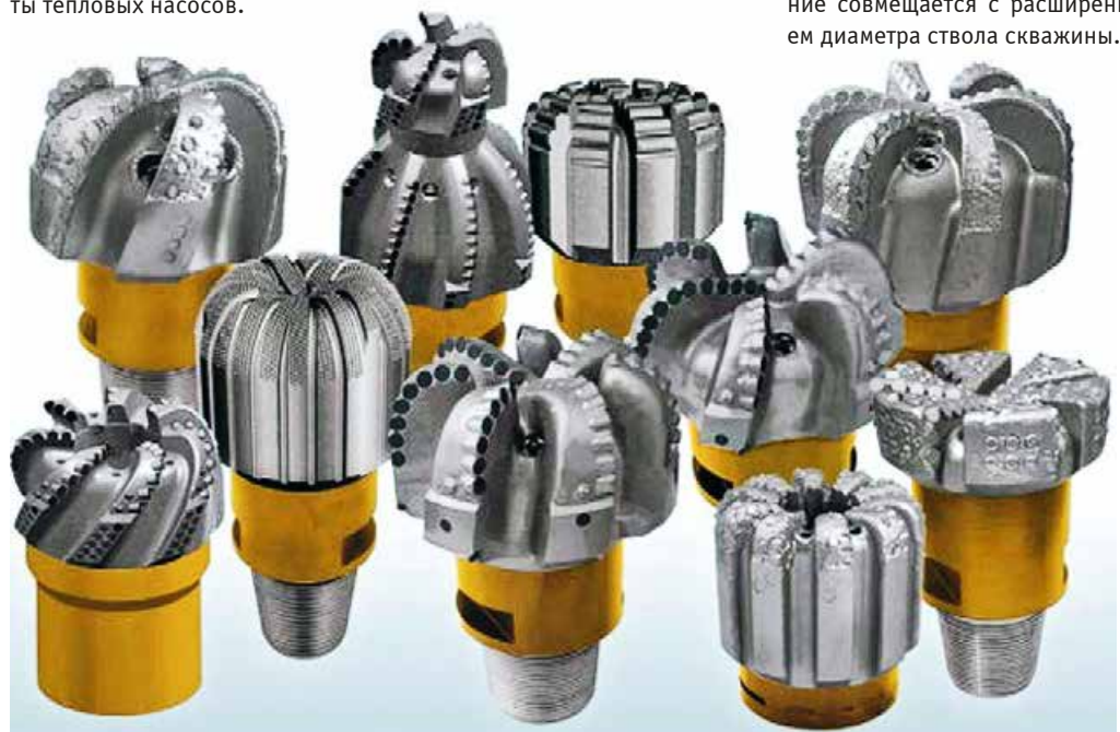
Алмазные долота применяются для разрушения небразивных пород средней и высокой твердости, рабочим органом в них является основание с поликристаллическими композитными вставками
