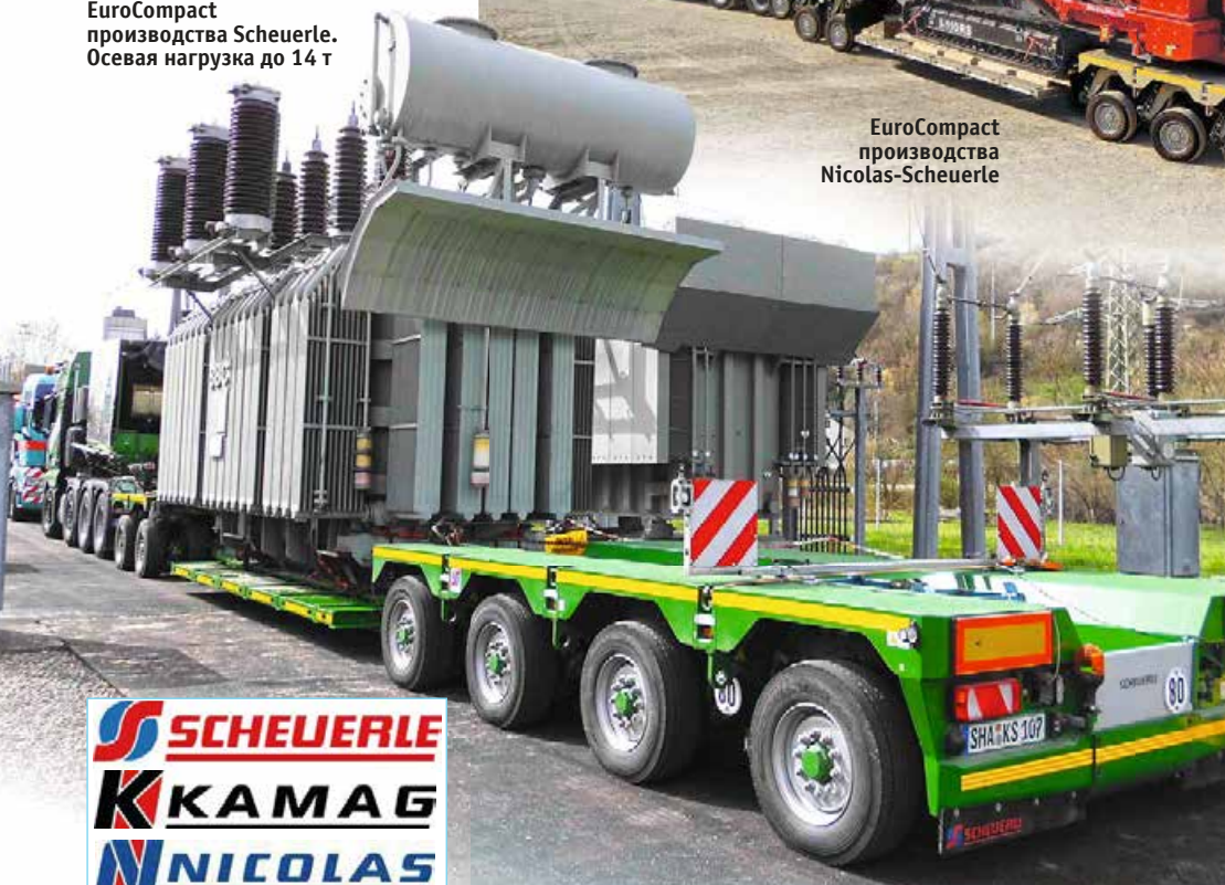
EuroCompact производства Scheuerle. Осевая нагрузка до 14 т
