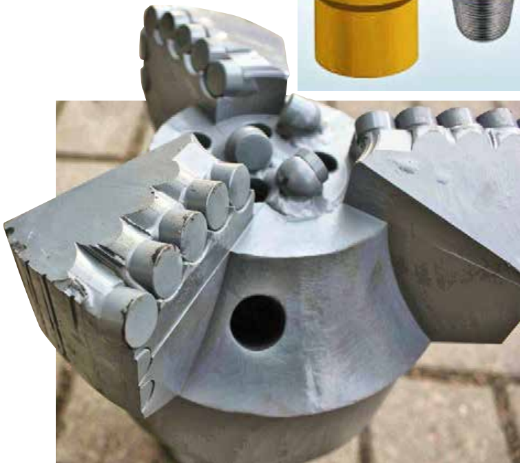
Алмазные долота применяются для разрушения небразивных пород средней и высокой твердости, рабочим органом в них является основание с поликристаллическими композитными вставками
