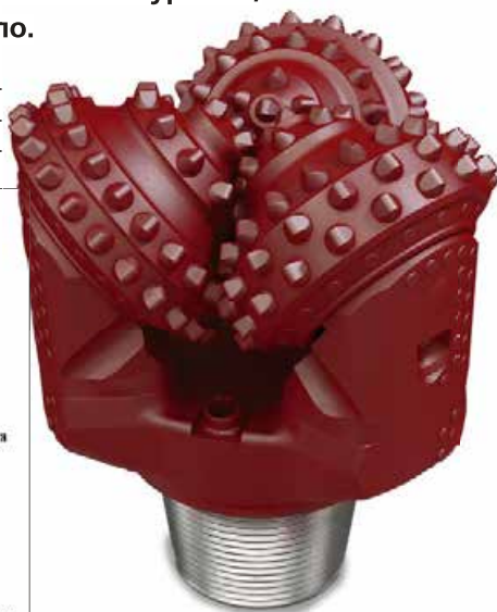
Основным элементом трехшарошечного долота для бурения является шарошка с зубьями из спекаемого карбидовольфрамового порошка
