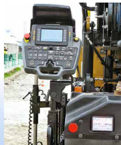
Одна из четырех панелей управления асфальтоукладчика AP655F. Команды на пульте переведены на русский язык
