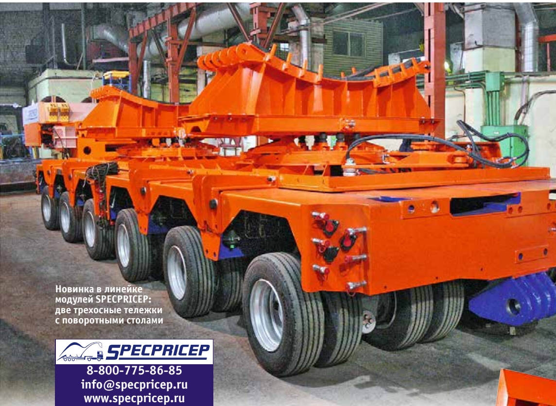
Один из модулей SPECPRICEP по просьбе заказчика дооборудован съемными гидротрапами для заезда спецтехники
