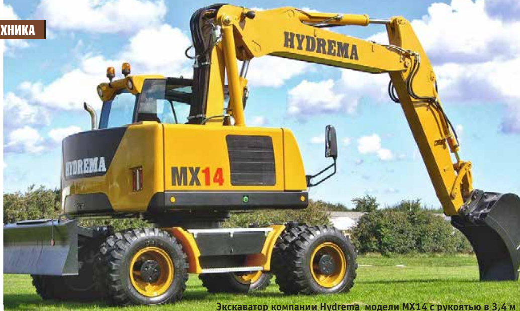
Экскаватор компании Hydrema модели MX14 с рукоятью в 3,4 м может работать на горизонтальном вылете до 9,16 м, при этом глубина копания достигает 5,28 м
