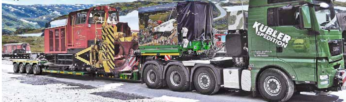
EuroCompact производства Scheuerle. Осевая нагрузка до 14 т
