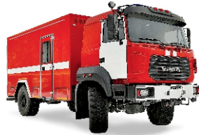
Пожарная насосная станция ПНС-120(Урал-43206) Special fire fighting pump station PNS-120(Урал-43206)
