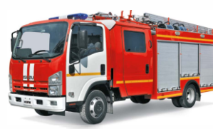
АЦ 1,5-40/2 (ISUZU NQR90L) стр.9 с установкой компрессионной пены АС 1,5-40 /2 (ISUZU QR90L) п.9 with the Compressed Air Foam System
